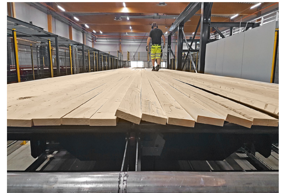
Die Formtoleranzen von Holzlamellen stellen in der Produktion von Brettsperrholz eine Herausforderung dar.
