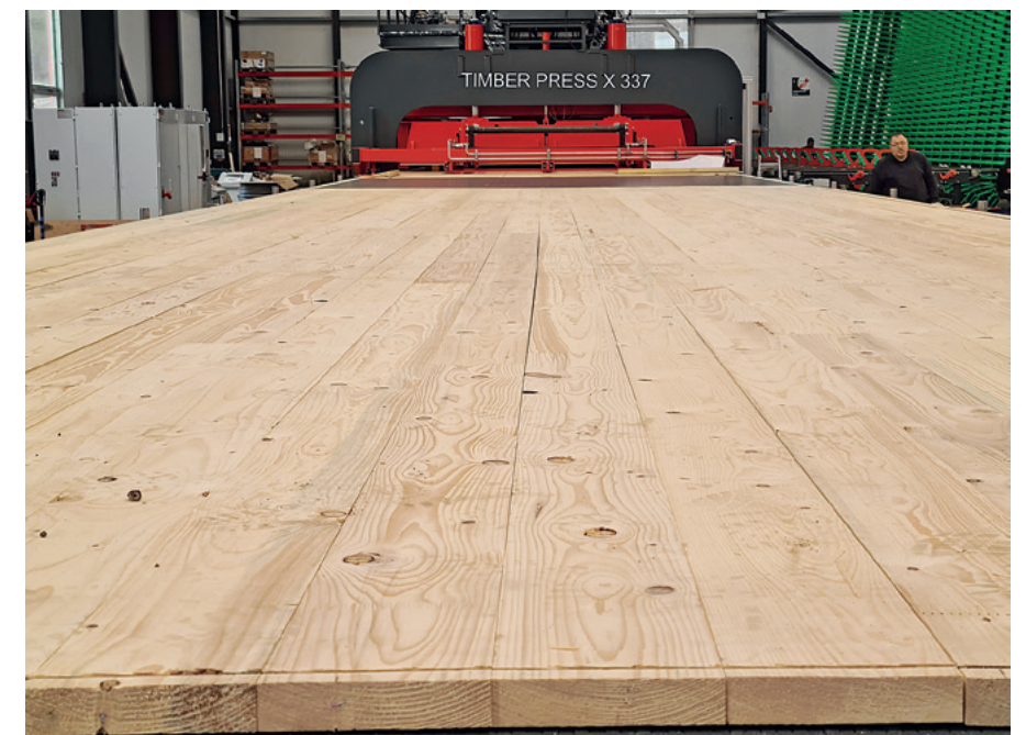
Innovative Lösung von Minda: gekederte Längslage in Vorbereitung auf den Pressvorgang
