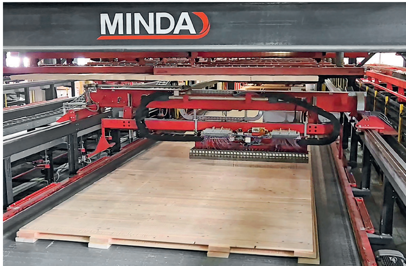
Herausgezogene Längslamellen zur Stabilisierung der Querlage
