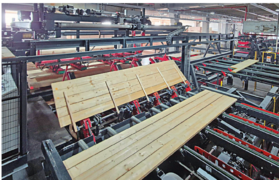
Bei der Vakuumentstapelung werden die Leisten abgekippt
