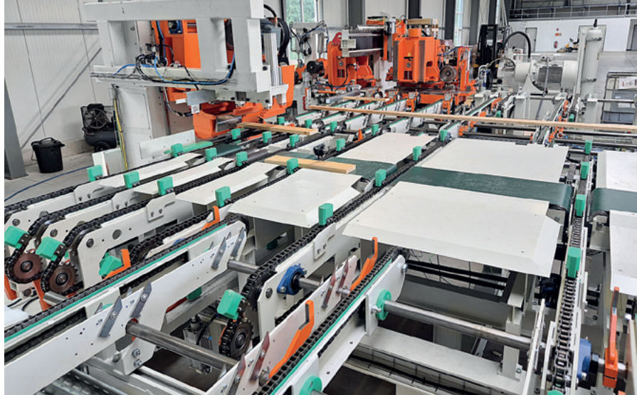
Die Keilzinkenanlage DuoZink12 während der Vorinbetriebnahme bei Minda
