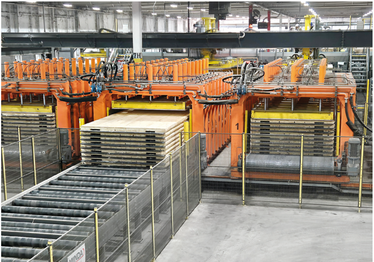
Drei BSP-Pressen des Typs TimberPress X 224 im Einsatz bei Sterling. Die fertigen Platten verlassen im Minutentakt die Anlagen
