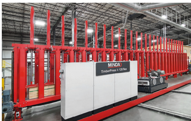
Für die Fertigung von Splitbeams hat Minda die BSH-Press TimberPress V 120 entsprechend modifiziert
