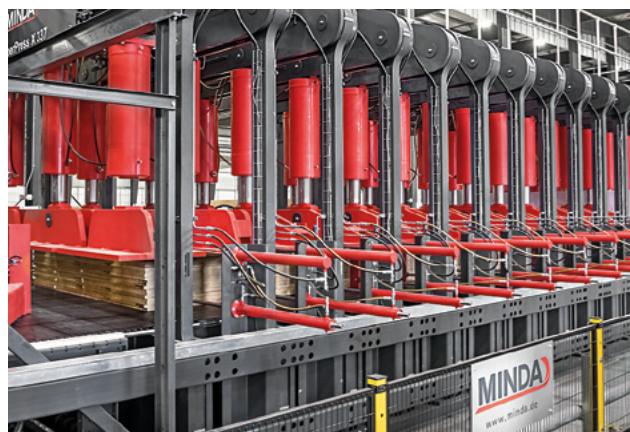
Die TimberPress X 337 verpresst Mass Ply Panels mit einem Pressdruck von bis zu 1 N/mm 2
